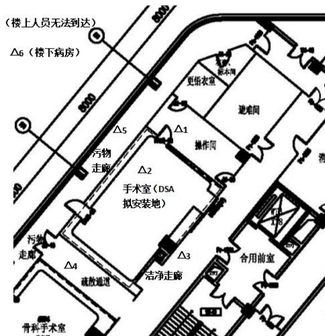
图 8-2 西院 DSA 机房拟建地监测布点示意图
